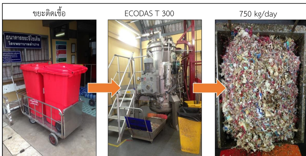
รูปที่ 4 การคัดแยกและกระบวนการบำบัดขยะติดเชื้อ
