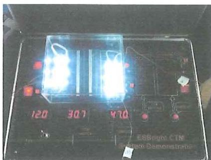
รูปที่ 8 การทดสอบการเปลี่ยนแปลงอุณหภูมิโดยรอบที่มีผลต่อโมดูลกำเนิดแสงแบบ LED
