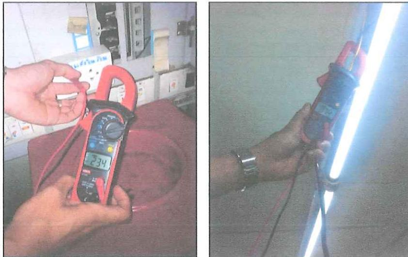
ก) การตรวจวัดค่าปริมาณแรงดันไฟฟ้า ข) การตรวจวัดค่าปริมาณกระแสไฟฟ้า
