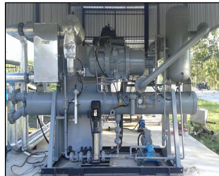
รูปที่ 3 เครื่อง ORC ต้นแบบขนาด 20 kW e (Hanbell : model SC2-300)
